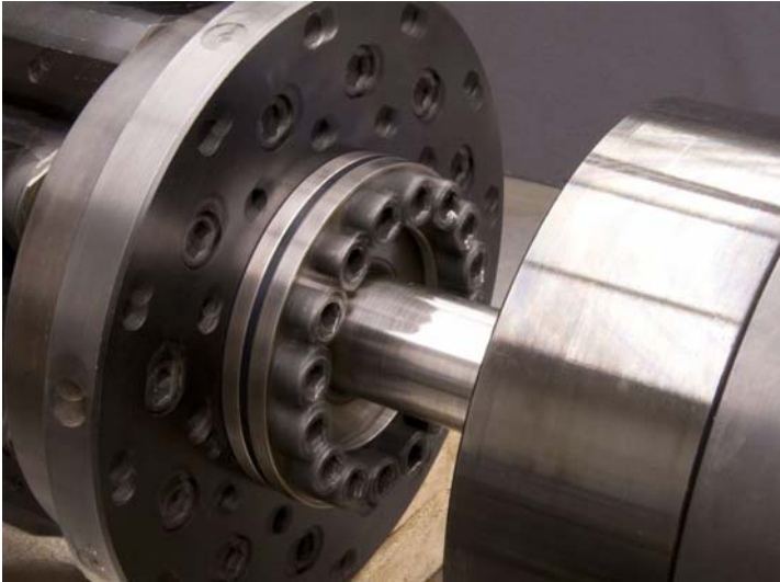
Abb. 2: Prüfkörper und Spannflansch während eines Torsionsversuches
