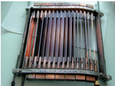
Bild 14: Filtermodul für industrielle Vakuumbogen-Beschichtungsanlagen. Der Filter kann an verschiedene Typen von Bogenverdampfern angepasst werden.
