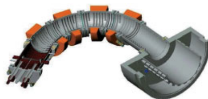
Bild 5: Filter-HCA-Modul für die Festplattenbeschichtung – Design und einsatzbereites Modul
