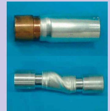
Abb. 3 : Aluminium-Kupfer-Verbindung (oben) und Aluminium-Aluminium-Verbindung nach einem Torsionsversuch (unten)
