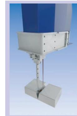
Abb. 2: *Schweißkopf für das Laser-MES-Verfahren (CAD-Darstellung)*
