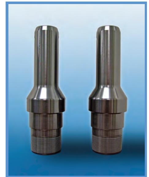
Abb. 3: Industrielles Schmiedewerkzeug, beschichtet mit einer 10 µm dicken Al-Cr-Si-Ti-N-Nanocomposit-Beschichtung
