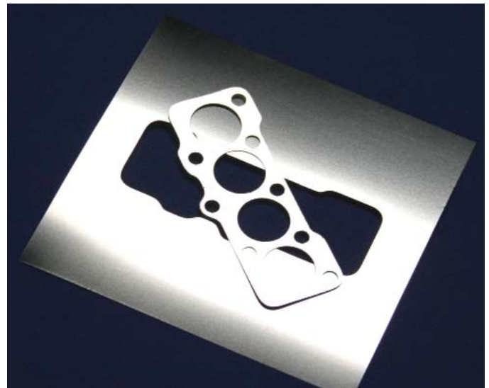
Abb. 3: Dichtungsgeometrie (ca. 80 mm x 30 mm x 0,5 mm) hergestellt durch flexibles Remote-Laserstrahlschneiden
