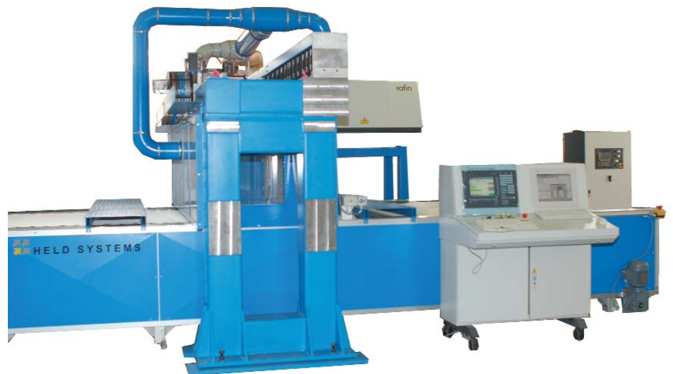
Abb. 3: Laseranlage »Contilas 2500 1Sc.« der Firma Held Systems Deutschland GmbH für die Airbagproduktion
