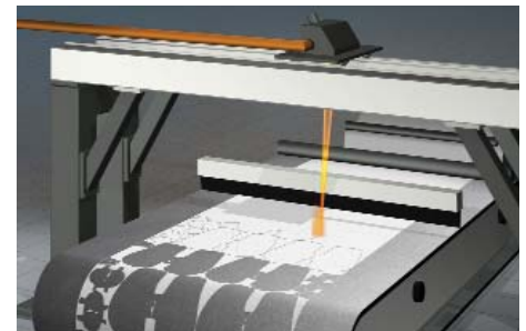
Abb. 2: Anlagenprinzip des Remote-Laserstrahlschneidens »on the fly«
