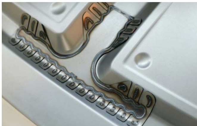
Abb. 2: Demonstrator Motorhaube mit randentspanntem Patch
