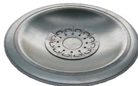
Abb. 1: Umgeformtes Modellteil mit optimierter Patch- und Schweißnahtkontur
