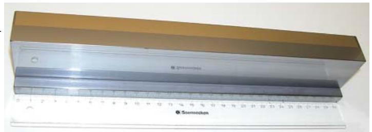
Abb. 2: Halbseitig Gold- und Mo/Si-beschichtete 310 mm-Optik
