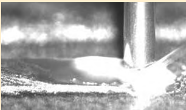
Prozess des koaxialen Laser-Draht-Auftragschweißens
