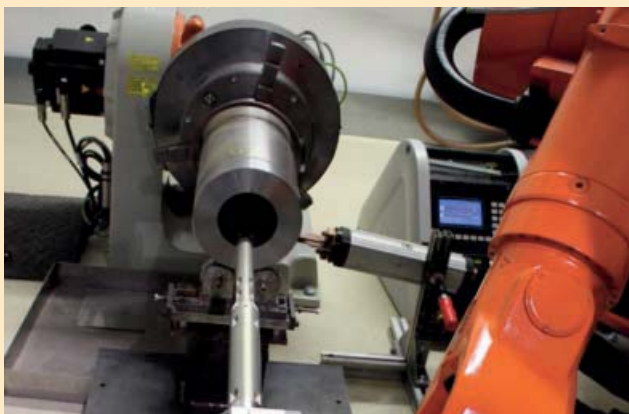
Schweißaufbau zum induktiv-unterstützten Innenrohr-Auftragsschweißen
