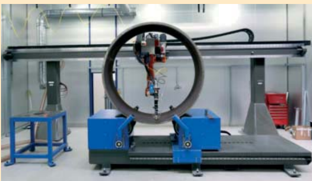
Anlage zum großflächigen Laser-Auftragschweißen von Behälterbauteilen mit Breitstrahlbeschichtungsoptik vom Fraunhofer IWS
