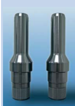
Schmiedewerkzeug mit glatter Hartstoffbeschichtung
