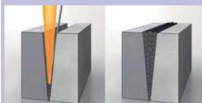
Prinzipbild des Laser-Mehrlagen-Engstspaltschweißens (MES)
