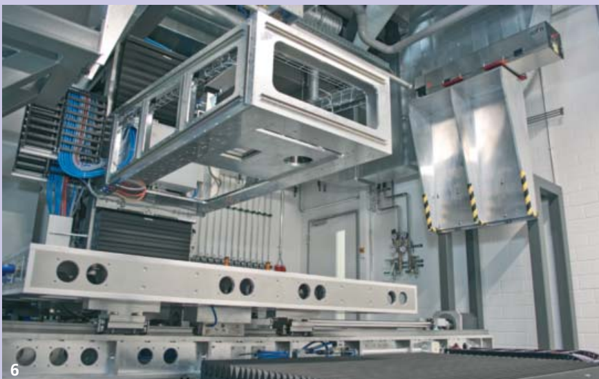
Anlage zur großflächigen Laser- und Plasmabehandlung
