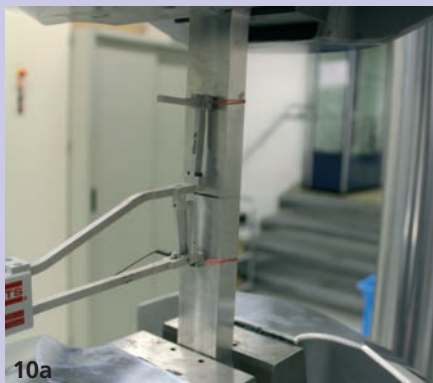
Charakterisierung der Laser-MES-Proben im Zugversuch (10a), Versagensverhalten einer Grundwerkstoffprobe (10b links) und einer MES-Schweißnaht (10b rechts)
