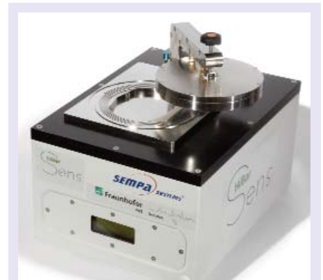
HiBarSens: Messsystem zur hochempfindlichen Bestimmung der Wasserdampfdurchlässigkeit ( WVTR = 10^{-5} \text{ g m}^{-2} \text{ d}^{-1} ) von Ultrabarierefolien
