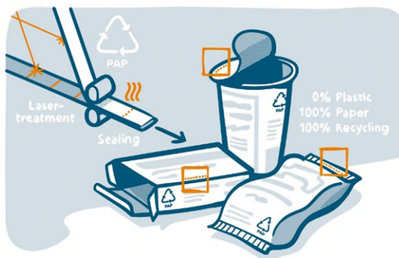
Abb. 1 Prozess zum fremdstofffreien Fügen einer lasermodifizierten Papierbahn
