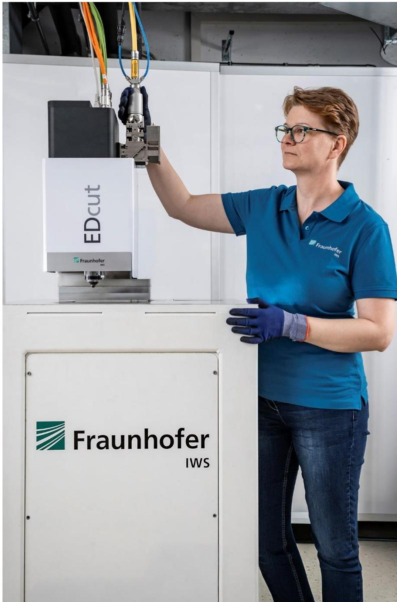
**Forschende des Fraunhofer IWS haben das EDcut-System entwickelt, das mit Festkörperlaser, Scanneroptik und Gasdüse Metalle und Verbundwerkstoffe mit geringen Materialstärken präzise schneidet.**
