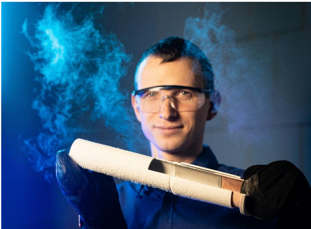
**Das Magnetpulsschweißen ermöglicht stoffschlüssige Verbindungen zwischen verschiedenartigen Materialien wie Kupfer, Aluminium und Stahl und erfüllt die Dichtigkeitsanforderungen auch bei sehr tiefen Temperaturen, beispielsweise in Systemen zum Speichern und Verteilen von flüssigem Wasserstoff.**
