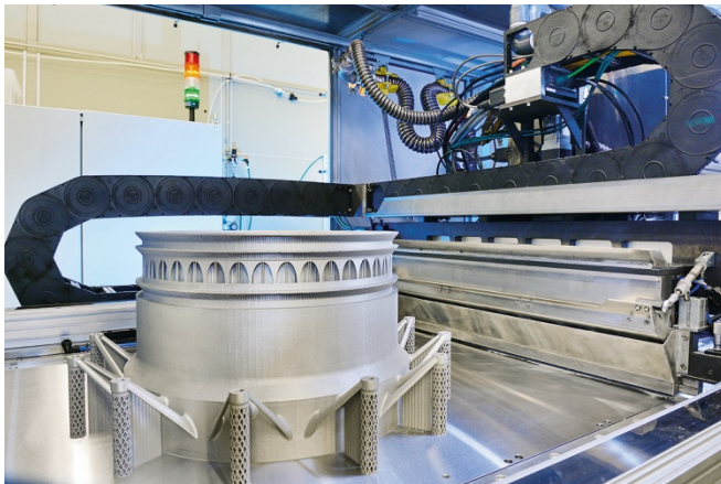
Bild 1: Mehrere Laser am Fraunhofer ILT in Aachen verwandeln Metallpulver per 3D-Druck in ein Demonstrator-Bauteil für die zukünftige Triebwerks- generation von Rolls-Royce. © Fraunhofer.
