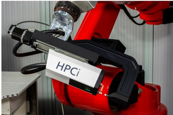
**Fügewerkzeug (HPCi®) zum thermischen Direktfügen mit einem Industrieroboter.**
