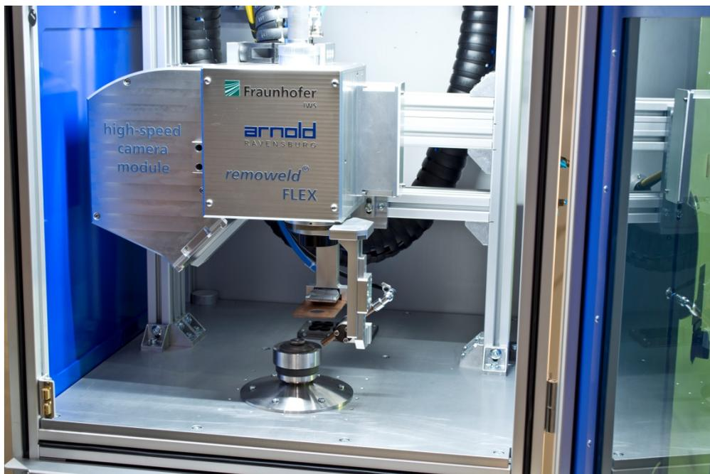
**Die Fraunhofer-IWS-Technologie unter der Bezeichnung »remoweld®FLEX« eignet sich für qualitativ besonders anspruchsvolle Prozesse, insbesondere für Bauteile, die gegen Wasser und andere unerwünschte Umwelteinflüsse mediendicht verschlossen werden müssen.**
