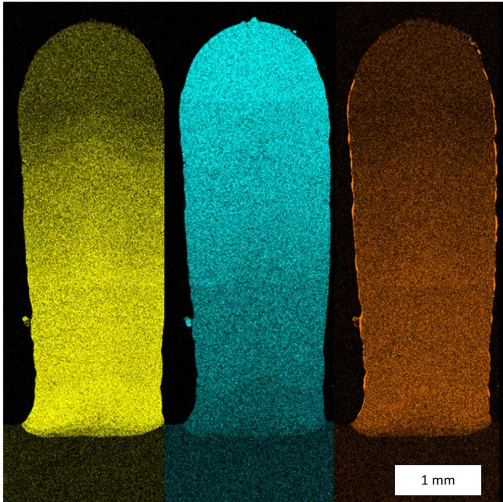
**EDX-Mapping: Die chemische Analyse einer Testgeometrie weist den Materialübergang nach. Die Farben veranschaulichen den stetigen Übergang von der Kobaltbasislegierung Merl72 zur Nickel-Basis-Superlegierung IN 718 (gelb: Kobalt, blau: Nickel, orange: Aluminium).**
