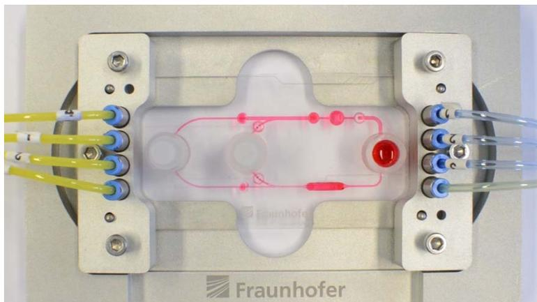
**Das gleiche Schema in der Praxis auf einem bereits angeschlossenen Multiorgan-Chip mit Pumpen und Ventilen (kleine rote Punkte) sowie den Kammern für Organe, Gewebe, Blut und Wirkstoffe.**
