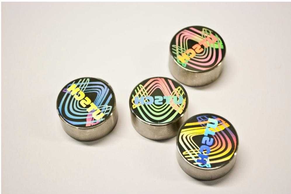
**Mittels DLIP-Verfahren hergestelltes exemplarisches Produktschutzmerkmal.**
