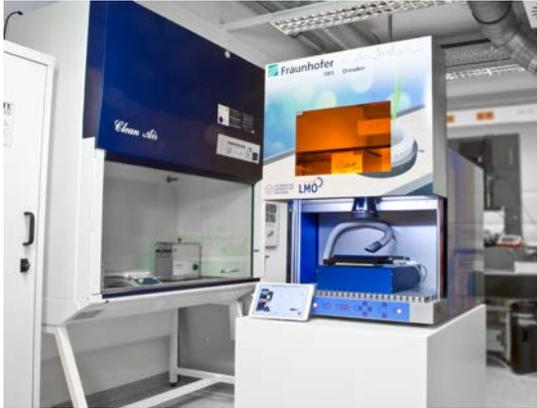
Kompakte Anlage zum direkten Laserinterferenzstrukturieren von Oberflächen
