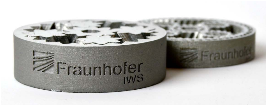
In einem Fertigungsschritt (ohne Fügen) hergestellte Planetengetriebe © Fraunhofer IWS Dresden
