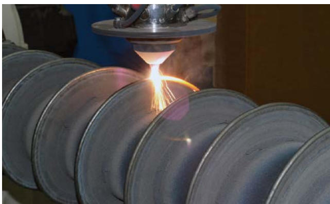
Laserbasierte additive Fertigung einer Extruderschnecke aus Edelstahl © Fraunhofer Center for Laser Applications CLA (USA)
