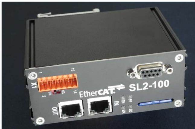
ESL2-100 Modul zur digitalen Ansteuerung von Galvanometerscanner über EtherCAT
