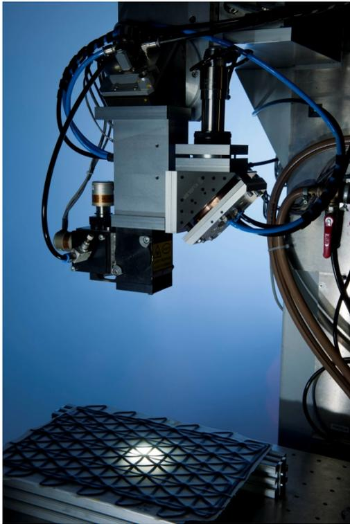
Multi-Wavelength Optik (MWO) zum Trennen von Isogrid-Strukturen aus CFK und GFK
