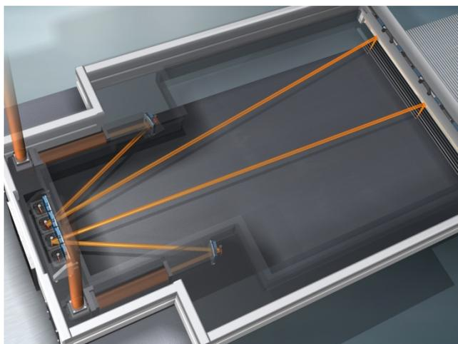
Prinzip des optischen Aufbaus (lasertronic® SAO x.x/6D) zur Laserbehandlung von kornorientiertem Elektroblech mittels zwei redundanter Strahlengänge (orange Linien = Laserstrahl)
