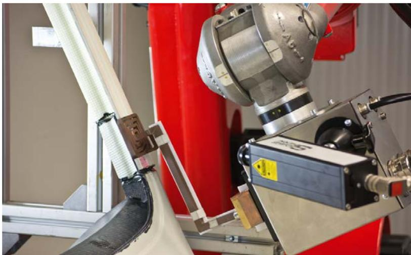
Pyrometergeregelte induktiv beschleunigte Klebstoffhärtung mit Industrieroboter
