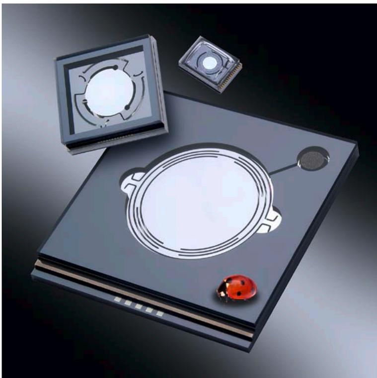
Die schnellen und widerstandsfähigen MEMS-Spiegel lenken den Laserstrahl ab und führen ihn präzise über das Werkstück. Sie halten nun auch hohen Energien stand, so dass sie Aluminium und Stahlbleche bearbeiten können.
