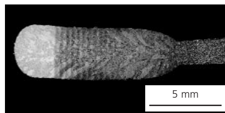
Abb. 3: Querschliff durch die aufgetragene Struktur, zu erkennen sind die Einzellagen und die lagenübergreifende Gefügestruktur
