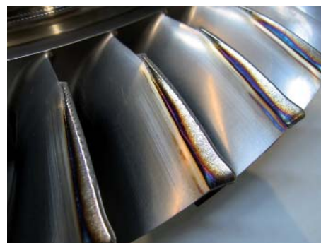
Abb. 2: Reparierte Kantengeometrien an beschädigter Blik vor der Endbearbeitung
