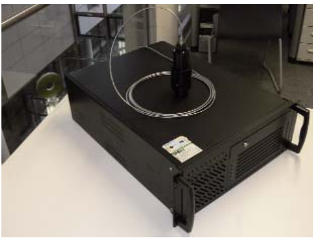
Abb. 2: Entwickeltes Mess- und Regelsystem (19"-Einschub mit Pyrometeroptik an Lichtleitfaser)
