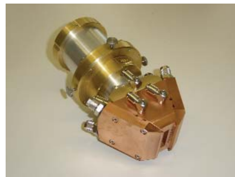
Abb. 2: Bearbeitungskopf COAX11 mit xyz-Justiereinheit und Anschluß zur Laseroptik
