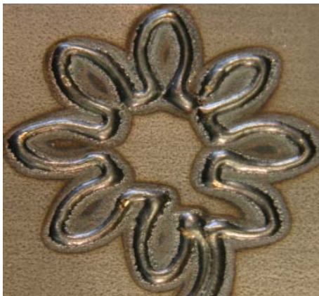
Abb. 2: Laser-Konturauftragschweißung mit zentrischer Drahtzufuhr (1,3 mm Raupenbreite)
